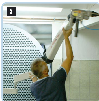
5 Put back the articulated arm Blockiert, erlaubt er die Erhöhung des Bereichs bis zu 2,5 m. Zablokowane, pozwala na uzyskanie do 2.5 m zasięgu
