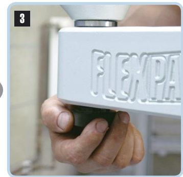
3 Realise the lock nut Der „Z“ Arm ist mit Mutter blockiert Ramię „Z“ jest zablokowane nakrętką
